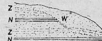
Rys. 5.4. Piętra wody gruntowej oraz "wodospad podziemny". Z - zwierciadło wody gruntowej, N - warstwa nieprzepuszczalna, W - tzw. wodospad podziemny
