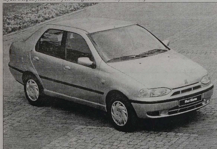
Klinowy kształt nadwozia porządkuje przepływ powietrza powodując, że współczynnik oporu aerodynamicznego jest bardzo korzystny – C_x = 0,33
