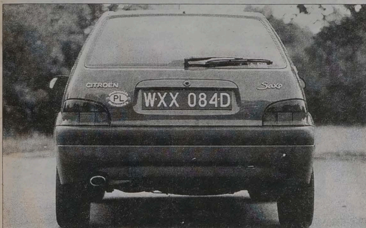
Saxo VTS otrzymało także inny zderzak tylny z podcięciem na wylot potężnej rury wydechowej
