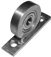
Rys. 3. Oprawa łożyska manipulatora
