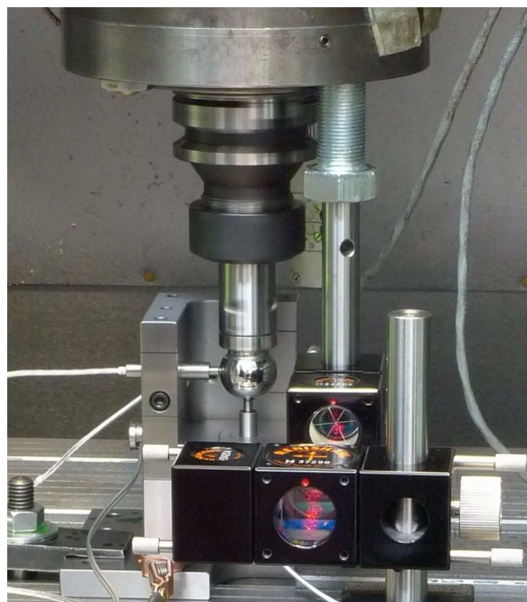
Rys. 6. Jednoczesne pomiary przemieszczeń drgań korpusu i przemieszczeń wirującej osi
