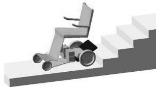
Rys. 4. Model symulacyjny wózka inwalidzkiego wykonany w systemie ADAMS
