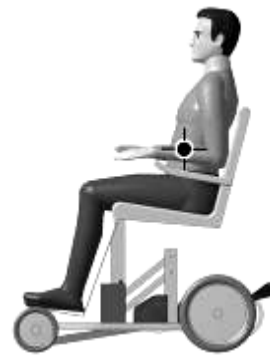
Rys. 3. Położenie środka ciężkości układu wózek-użytkownik dla prezentowanego modelu symulacyjnego
