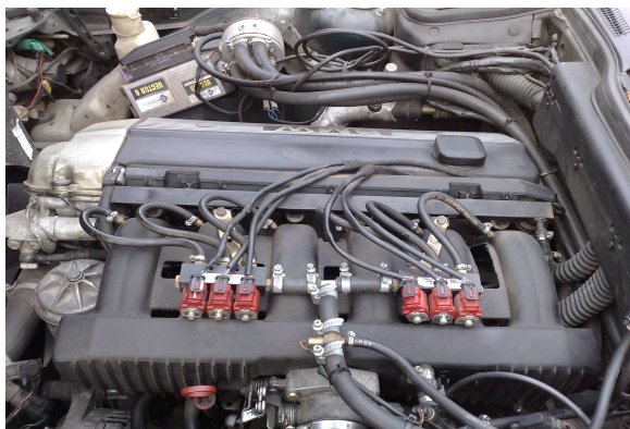
Rys. 2. Silnik M50B20 wyposażony w sekwencyjną instalację LPG
