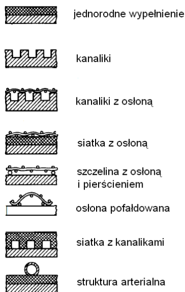
Rys. 4. Przykłady struktur kapilarnych dla poziomych rur cieplnych (Reay i Kew, 2006)
