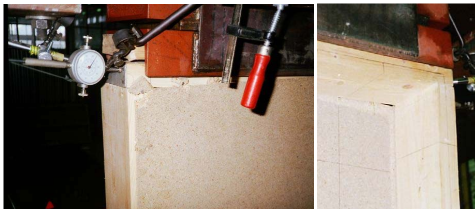
Rys. 18. Zniszczenie łączników w narożu płyt poszycia, badania [1]
