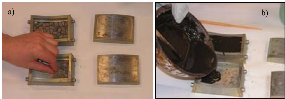
Rys. 5. Przygotowanie próbek do badania odporności na polerowanie: a) układanie kruszyw w formie; b) zalewanie kruszyw żywicą
