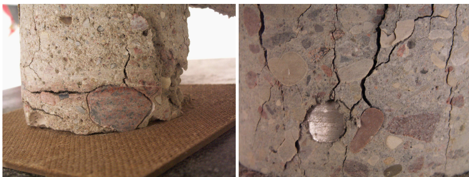
Rys. 3. Elementy uzyskane metodą odwiertów rdzeniowych, badane zgodnie z technologią [16], widoczne frakcje kruszywa grubego oraz pręty zbrojenia konstrukcyjnego
