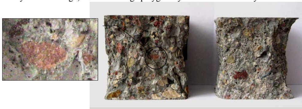
Rys. 6.2. Próbkki po badaniu wytrzymałości na ściskanie, odpowiednio: B0 (z lewej) i B2 (z prawej)
