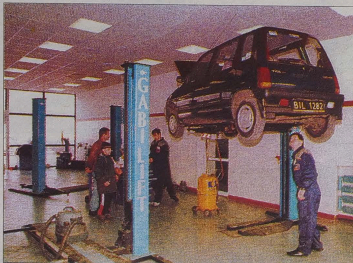
Stacja serwisowa z szerokim zakresem czynności obsługowo-naprawczych. Na zdjęciu: kontrolowanie podwozia Daewoo Tico.
