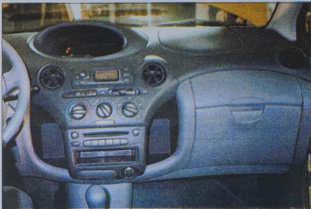
Tę owalną tablicę widzi tylko kierowca. Są na niej wyświetlane wszystkie potrzebne informacje.
