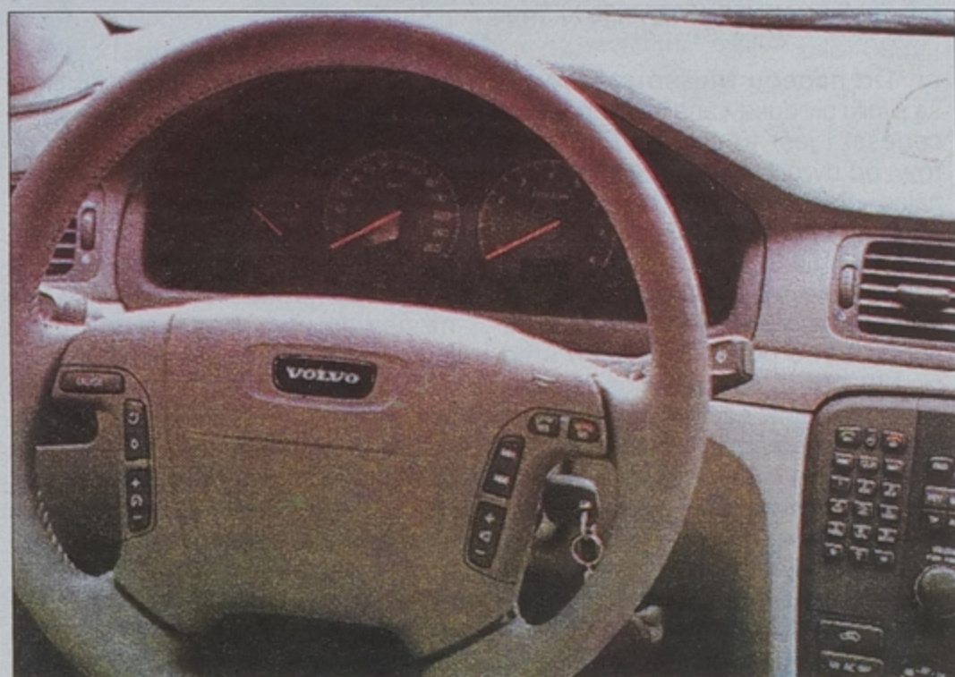
To ma przed sobą kierowca. W kole kierownicy są przyciski sterujące wieloma funkcjami, od tempomatu po telefon komórkowy.
