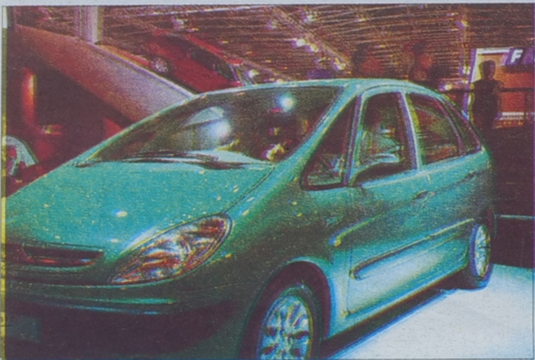
Ostry kąt pochylecia pokrywy silnika i szyby przedniej – przy wyższej pozycji kierowcy – dają w efekcie doskonałą widoczność. Drzwi boczne chronią solidne listwy.
