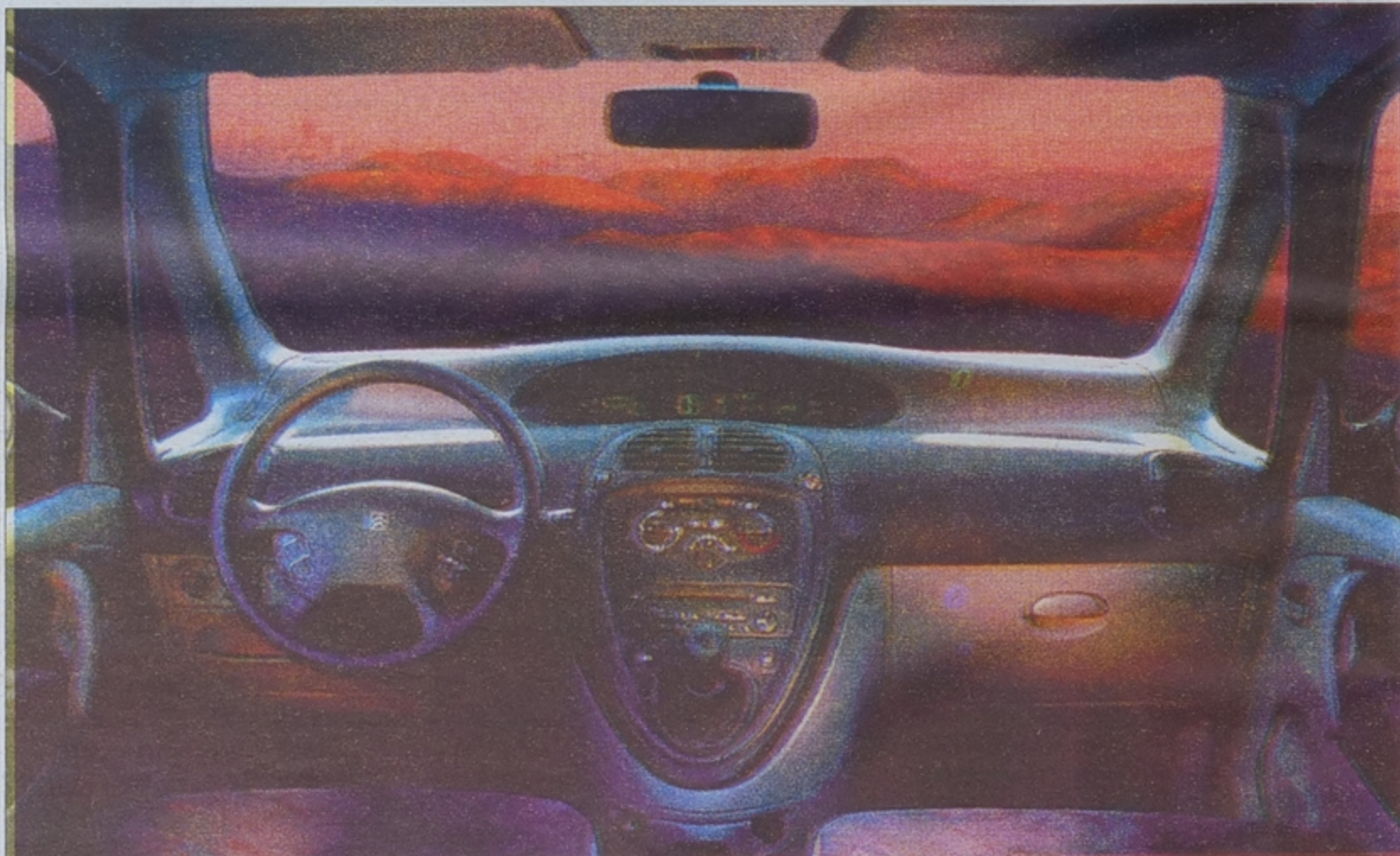
Zagospodarowanie miejsca pracy kierowcy może budzić kontrowersje. Tablica rozdzielcza umieszczona jest centralnie...
