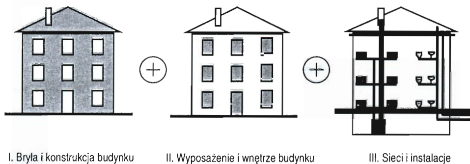
Rys. 2. Zakres oceny elementów budynku
