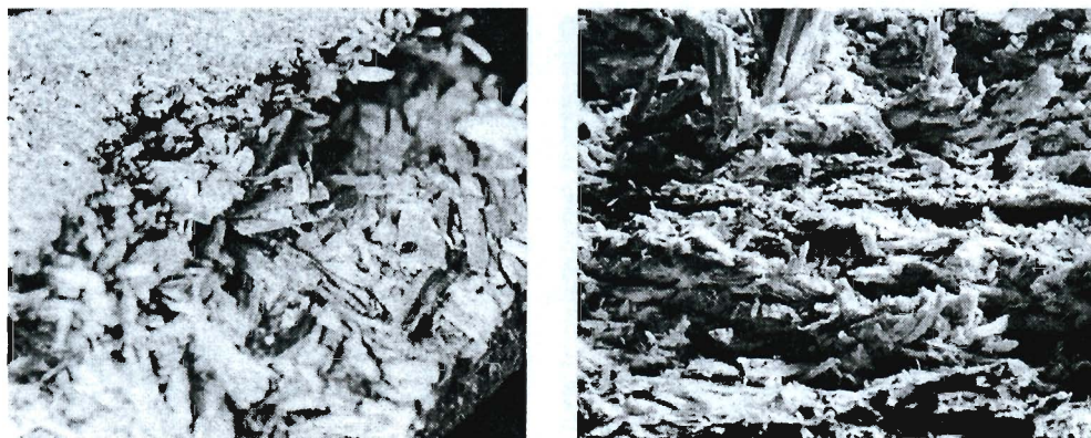
Rys. 7. Degradacja właściwości mechanicznych we fragmentach przekrycia strukturalnego i całkowite eliminowanie cech sprężystych spowodowane procesem pęcznienia
