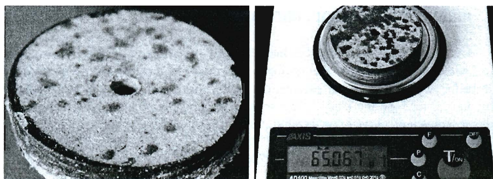
Rys. 3. Proces pomiarów wilgotności materiału z wykorzystaniem próbek pobieranych z fragmentów płyt przekrycia o zróżnicowanych ugięciach
