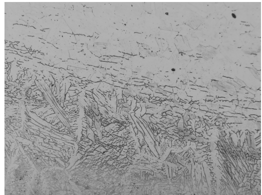
Rys. 11. Mikrostruktura obszaru granicznego, spoina – materiał podstawowy, od strony stali austenitycznej, spoiwo C
