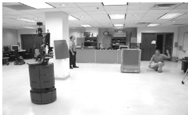
Rys. 6. Scenariusz misji zwiadowczej: robot, cel (człowiek stojący) oraz członek drużyny (osoba kucająca) (Kennedy i inni, 2007)
