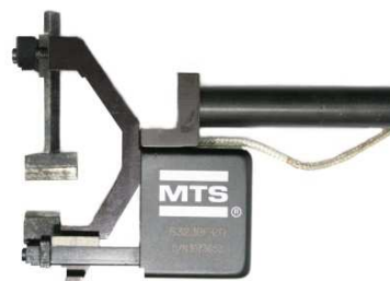
Rys. 4. Ekstensometry: (a) osiowy Epsilon 3542-050M-025-HT1, (b) średnicowy MTS 632.18F-20
