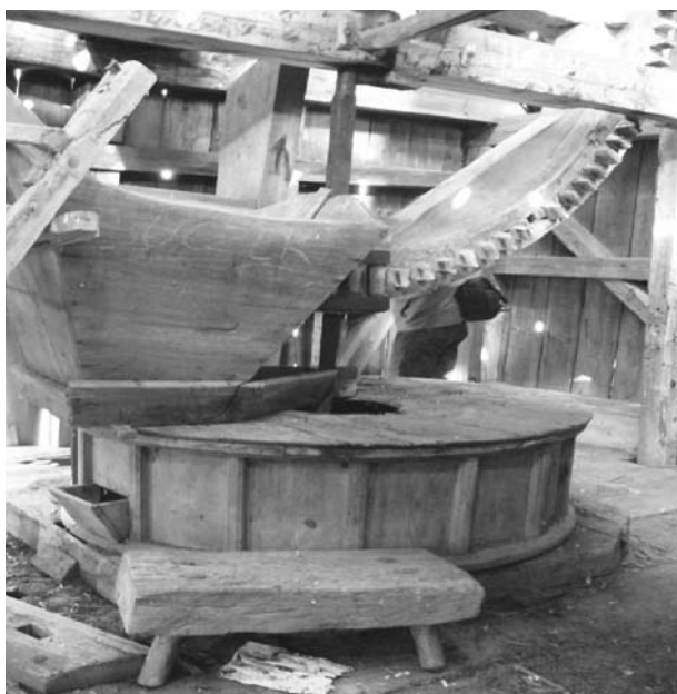
Ryc. 10. Wiatrak z Dębna przed demontażem - drugie piętro; widoczny mlewnik osłonięty dziżą, kosz zasypowy i fragment koła Palecznego. Fot. autorka
