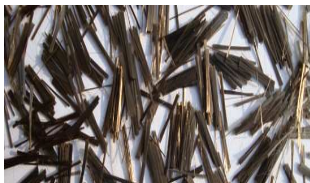
Rys. 8. Włókna polimerowo-bazaltowe (fiberbet.eu)
