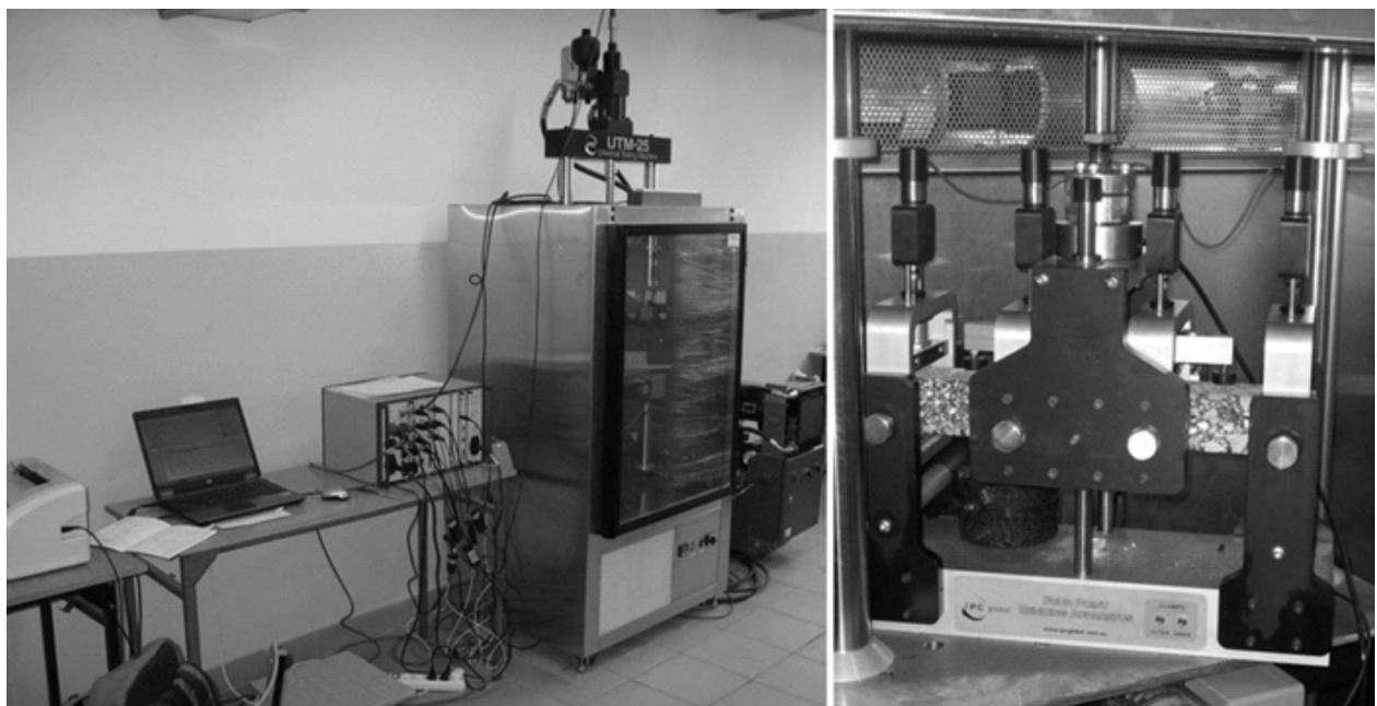
Rys. 5. Aparatura UTM-25 do oznaczenia trwałości zmęczeniowej mieszanek mineralno-asfaltowych
