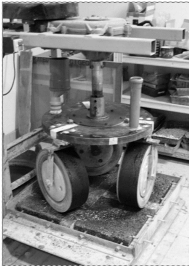
Rys. 1. Stanowisko badawcze – polerka płytowa
