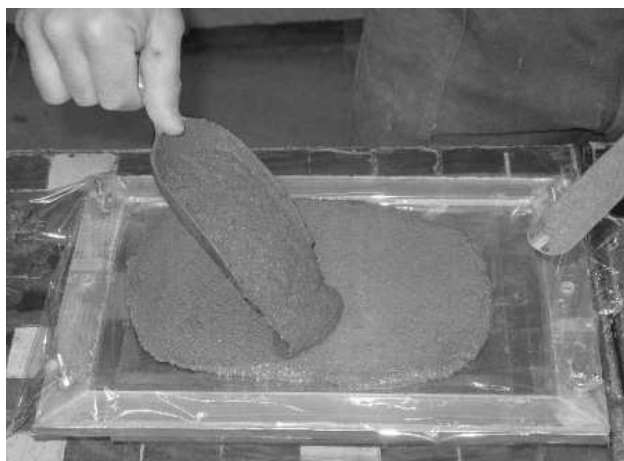
Rys. 1. Przygotowanie próbki zaprawy do badania skurczu
