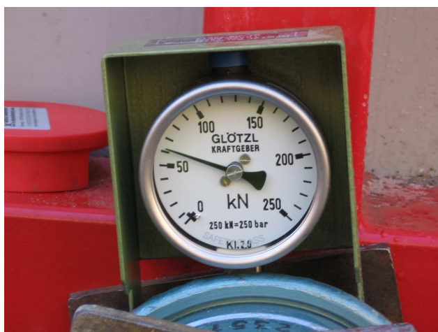
Fot. 9. Tensometr do kontroli parcia i prędkości układania mieszanki betonowej
