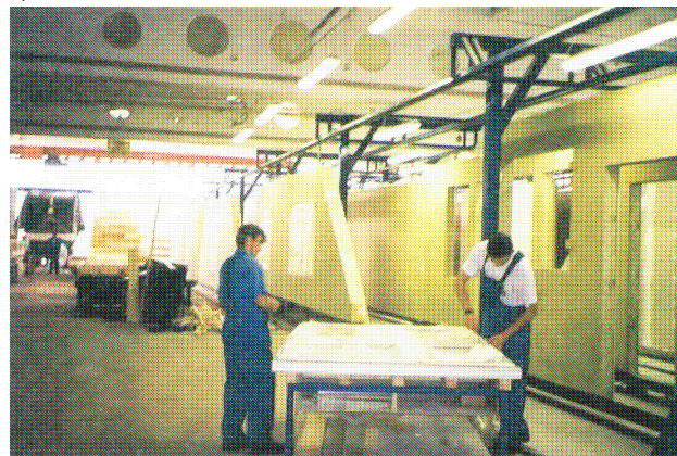
Rys. 7. Stanowiska produkcyjne: a) poziome potokowej linii produkcyjnej, b) regały pionowe potokowej linii produkcyjnej
