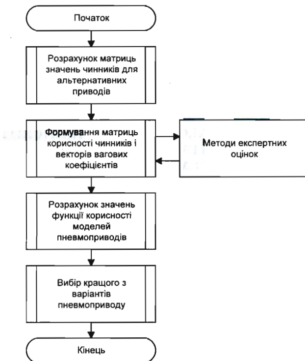
Рис. 4. Схема алгоритму вибору кращого варіанту пневмоприводу за критерієм сумарної корисності
