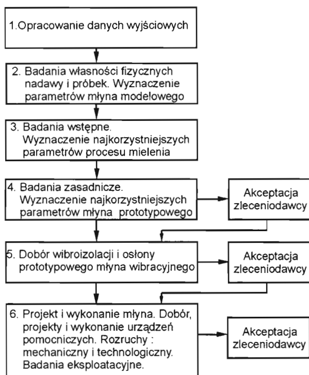
Rys. 1. Procedura syntezy konstrukcji prototypowego młyna wibracyjnego
