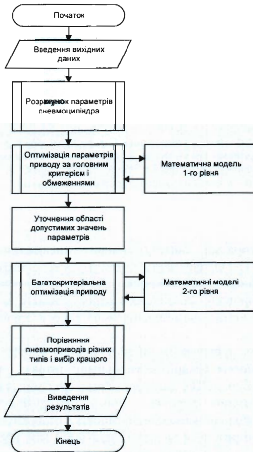
Рис. 1. Узагальнена схема алгоритму оптимізаційного синтезу пневмоприводу
