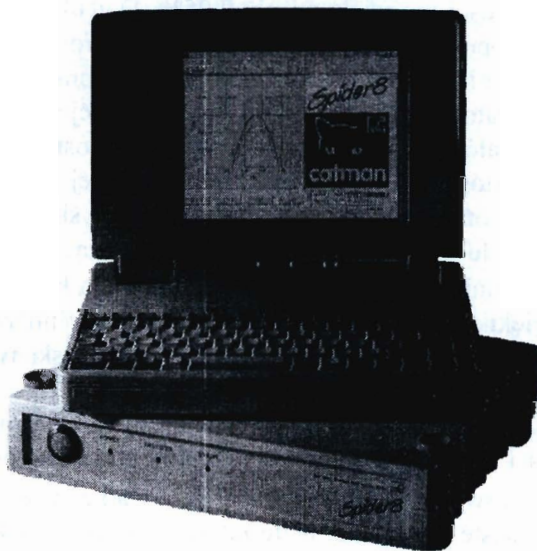
Rys. 5. Analizator drgań SPIDER8 firmy Hottinger BMT
