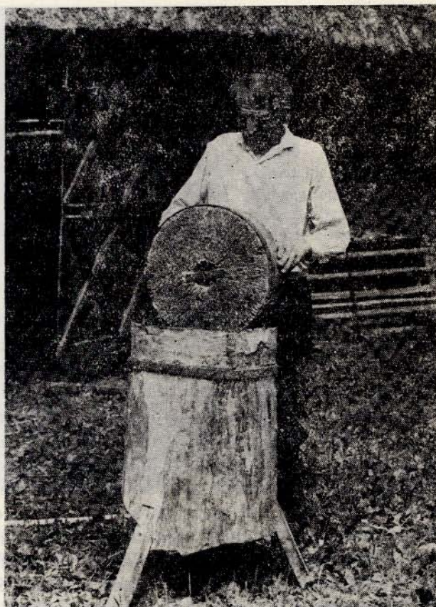
Ryc. 51. Drewniane żarna z nabijanymi kawałkami żelaza. Wieś Posejny pow. Sejny
