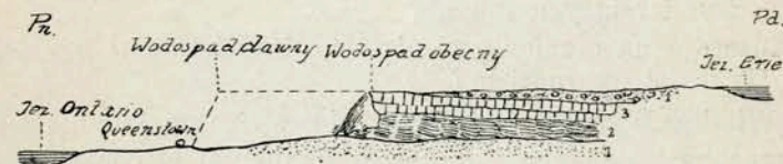
Fig. 58. — Przekrój przez wodospad Niagara. 1. piaskowce, 2. miękkie łupki; 3. twarde wapienie; 4. aluwia.
