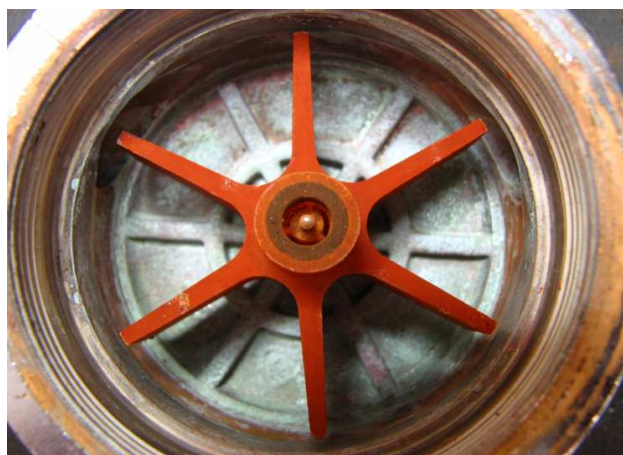
Rys. 1. Wodomierz jednostrumieniowy suchobieżny – komora pomiarowa
