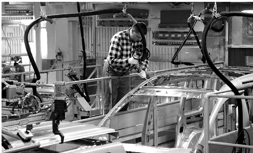
Rysunek 2. Klejenie poszycia dachu samochodu osobowego
