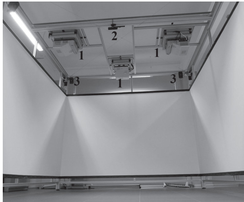
Ryc. 1. CAVE na Wydziale Architektury Politechniki Białostockiej. 1 – rzutniki, 2 – czujnik ruchu, 3 – system audio. Fot. autor
