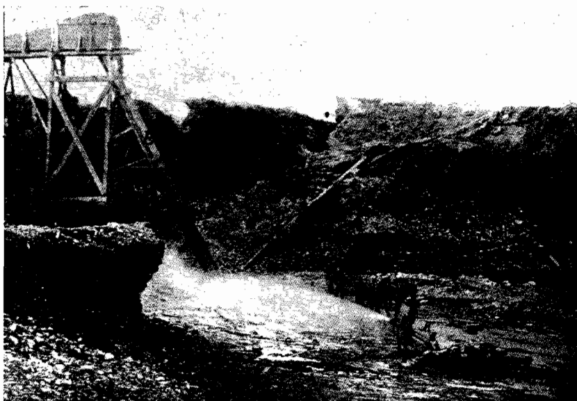
Rys. 207. Elewator hydrauliczny E w kopalniach złota na Alasce (Nome); t — rura naporowa; M — monitor, zapomocą którego spłukuje się w przodku materiał do żąpia elewatora.
