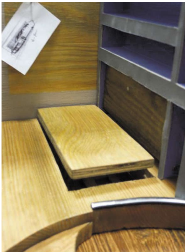
Ryc. 13. Początkowa faza (ryc. 11) wynoszenia spod podestu dodatkowego blatu do pracy; autor M. Olkowski (temperament – sangwinik/choleryk, wzorzec – WRS/RWS, AiUI, 2010/11)
