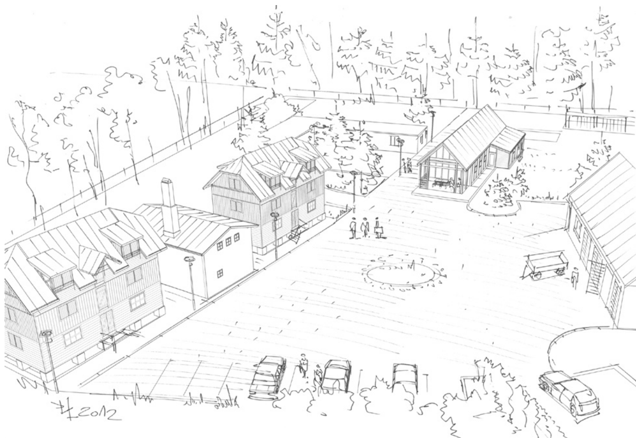
Ryc. 2. Widok zespołu obiektów z najbliższym zagospodarowaniem terenu – dwa drewniane budynki magazynowe i łącząca je murowana wyluszcarnia, u góry budynek magazynowy adaptowany na salę konferencyjną; źródło: szkic poglądowy autorstwa dra inż. arch. Piotra Łodzińskiego, 2011 r.
