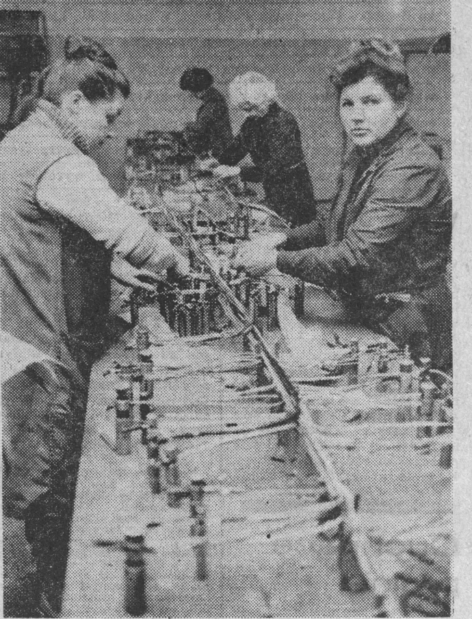
Na stole montażowym wiązek w Zakładach Elektrotechniki Motoryzacyjnej „Polmo” w Elku powstają kolejne zestawy osprzętu.
