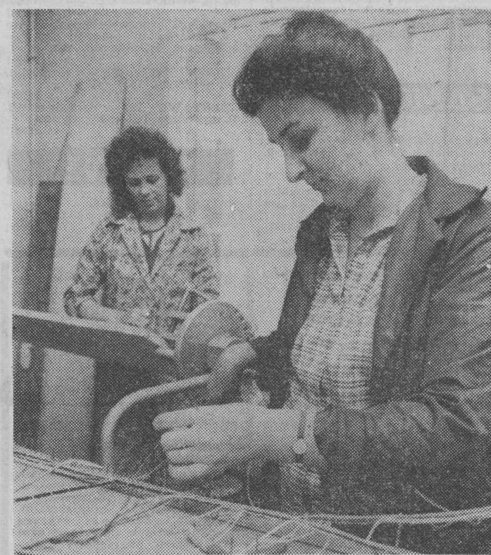
Maria Kowalewska i Maria Kostecka wykonują wiązkę przewodów do stojaków urządzeń kontrolnych.
