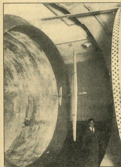
Ryc. 64. Wnętrze Instytutu Aerodynamicznego: model szybowca zawieszony w przerwie kanału, przez który przepływa prąd powietrza o wielkiej prędkości.
