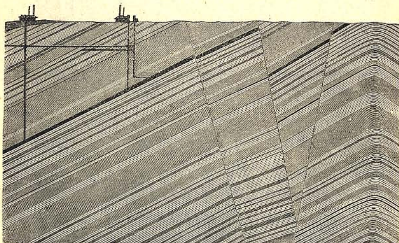
Przecięcie będzińskiego pokładu węgla kamiennego pod kopalnią Niwka. (Pokład węgla oznacza czarna, gruba kresła ukośna).
