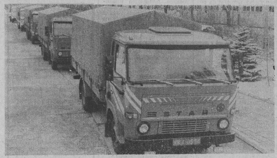
W Fabryce Samochodów Ciepłowych w Starachowicach powstała seria prototypowa samochodów Stary 742. Tego typu samochód z silnikiem czterocylindrowym wysokoprężnym jest bardzo potrzebny w handlu wewnętrznym oraz w rolnictwie ze względu na paliwo — olej napędowy i jego niskie zużycie (14 litrów na 100 km przy ładunku 3,2 tony). Ma ponadto dużą skrzynię ładunkową z uisko położoną podłogą.
