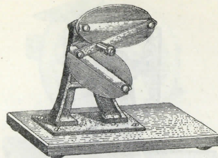
765. ЦЕНТРОИДЫ АНТИПАРАЛЛЕЛОГРАМА, УСТАНОВЛЕННОГО НА МАЛОЕ ЗВЕНО
