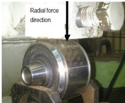
Fig. 3b. Actual bushing installed in test rig
