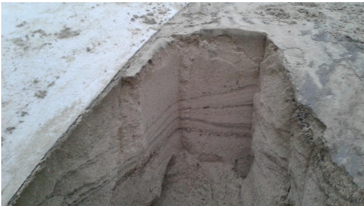
Rys. 7. Uwarstwienie gruntu wewnątrz georury (fot. B. Smoliński)
