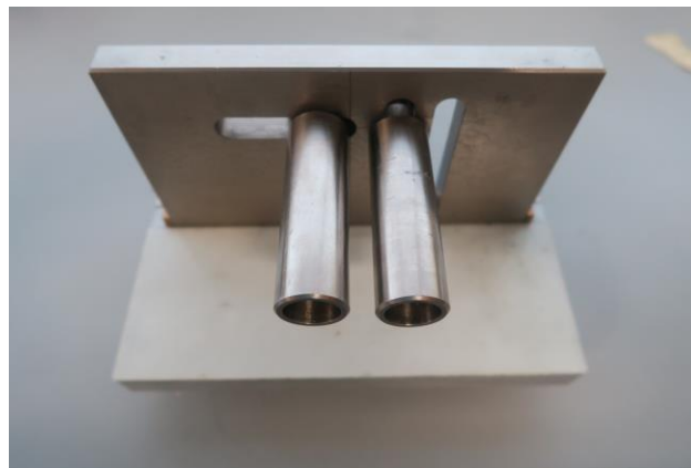
Rys. 3. Oprzyrządowanie do badania wytrzymałości siły odrywania
