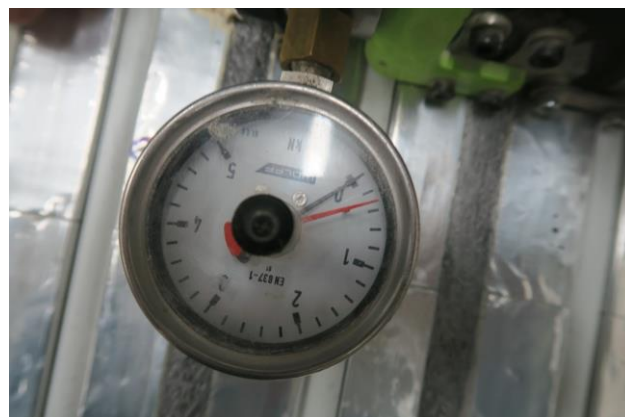
Rys. 15. Wynik badania wytrzymałości na ścinanie przy punktowym mocowaniu posadzki drewnianej
