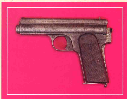
7,65 mm pistolet Frommer Stop wz.12, Austro-Węgry, Budapeszt, po 1912 r., wym. 11,5 x 16 cm, nr inw. MWB/3894; opis: Broń składa się z lufy, urządzenia spustowego i celowniczego, komory zamkowej, zamka, kurka, okładzin i magazynka. Na komorze zamkowej z lewej strony broni znajduje się wybity napis: „FEGYVERGYAR – BUDAPEST FROMMER – PAT. STOP CAL. 7,65 MM (32)”. Na szkielet z lewej strony nr broni „293244, a przy spuście litery „Sr” w kwadratowej ramce. Okładki drewniane koloru brązowego.
