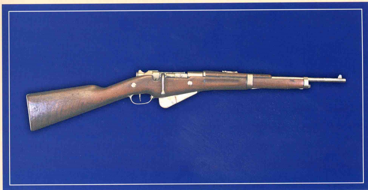
Karabinek Berthiera Mle1892 M16 (Berthier Mle1916), ok. 1918 r., kal. 8 mm, dł. broni 94,5 cm, pojemność magazynka 5 sztuk, nr. inw. MWB/93, nr. fabr. „AE 25066” powtórzony na ręczce zamka, kabłąku i kolbie. Na lewej płaszczyźnie komory zamkowej „ST.Etienne Mle M16”.
