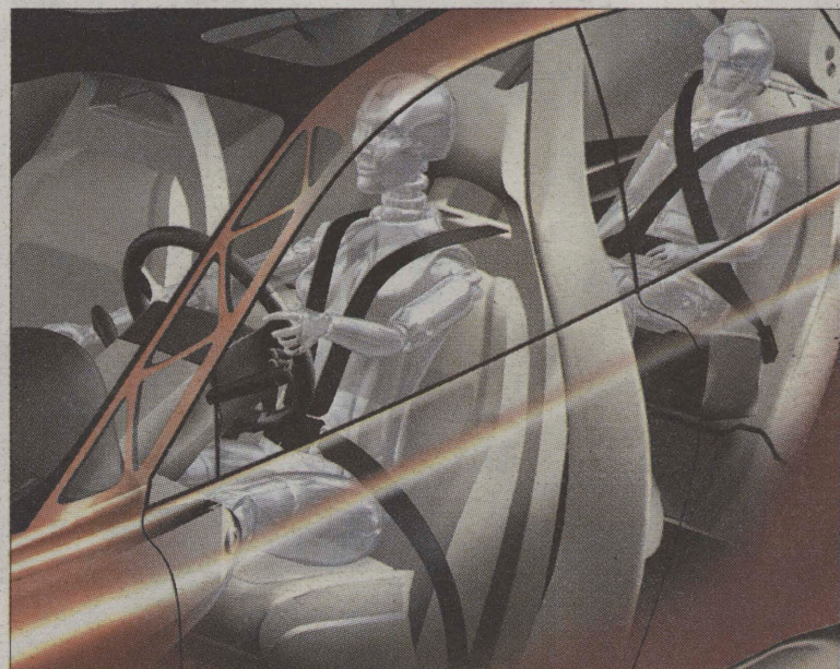
Volvo SCC – proszę zwrócić uwagę na konstrukcję przedniego słupka i czteropunktowe pasy bezpieczeństwa na wszystkich siedzeniach
