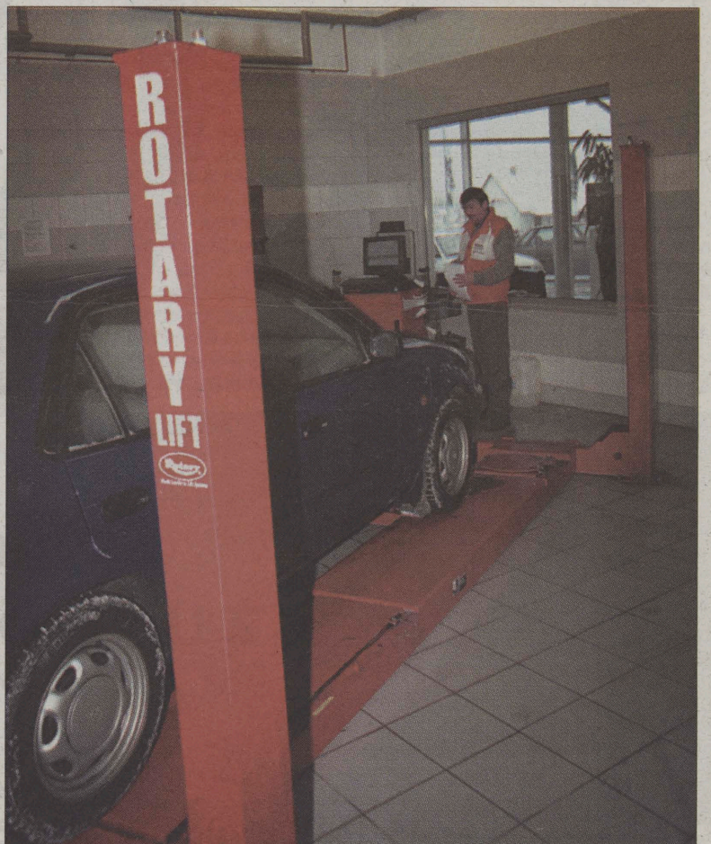
Stanowisko podnośnikowe do diagnozowania i napraw podwozia
