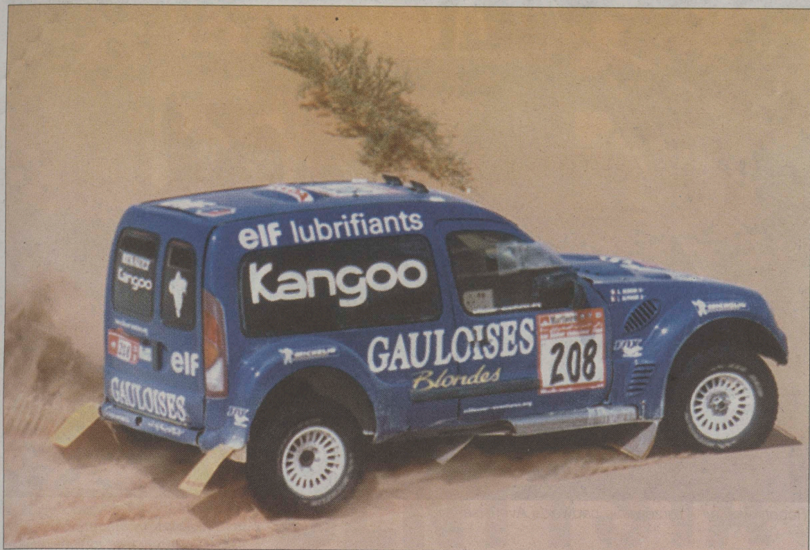
Specjalnie przygotowane Renault Kangoo – z napędem 4x4 i silnikiem o mocy 300 KM
