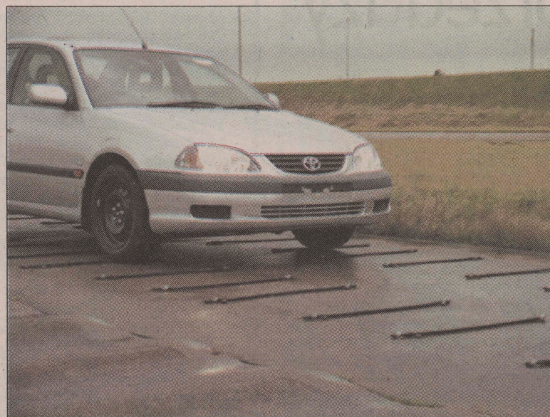
Męczenie zawieszenia na torze najeżonym nierównomiernie rozłożonymi progami
