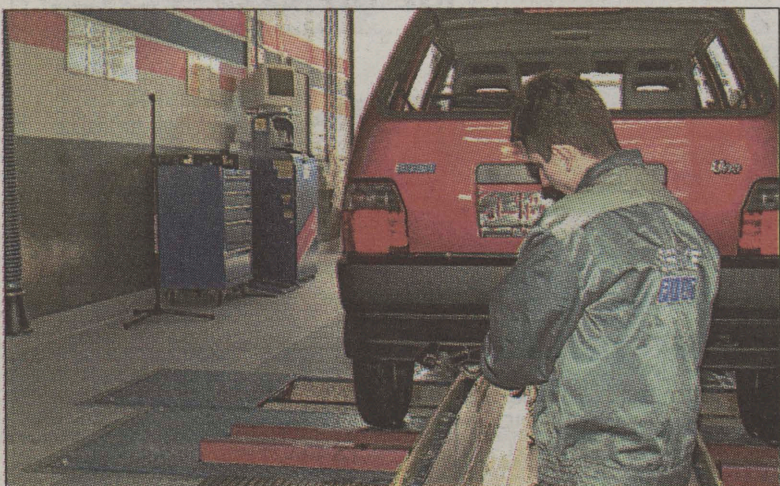
Sprawdzanie składu spalin. Do kontrolowania ich czystości przywiązuje się coraz większą uwagę.
