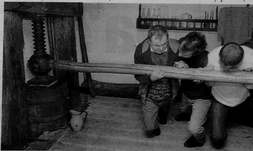
Prasa do tłoczenia oleju z rzepaku (sprzed ok. 100 lat)
