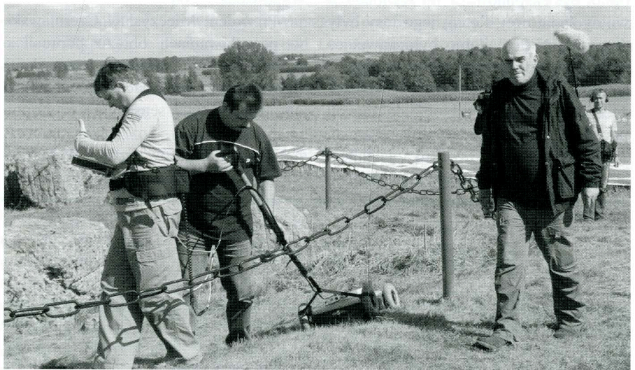
Badania wzgórz w Górze Strękowej z użyciem georadaru
