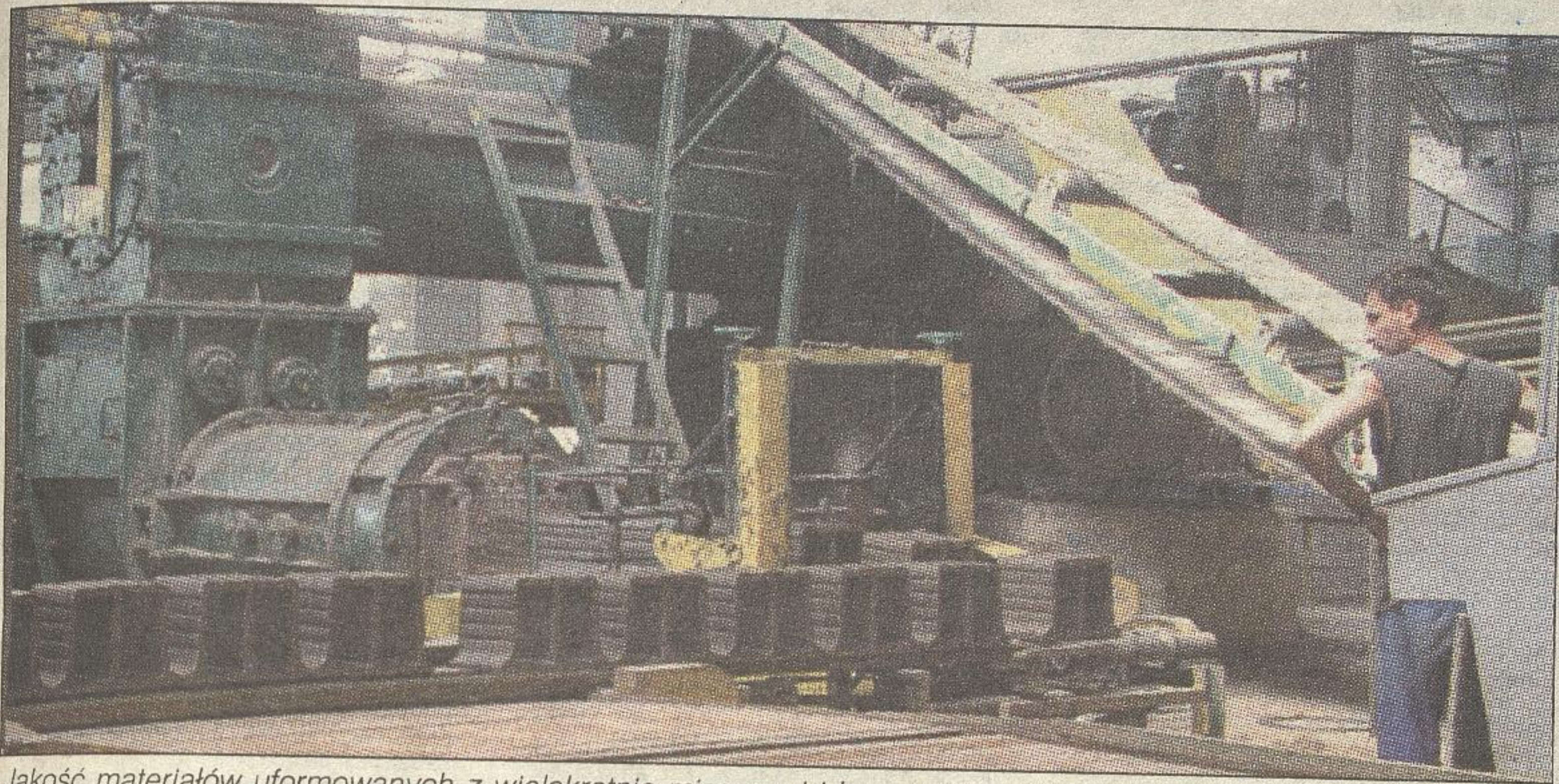
Jakość materiałów uformowanych z wielokrotnie mieszanej i homogenizowanej masy ceramicznej jest dokładnie kontrolowana
