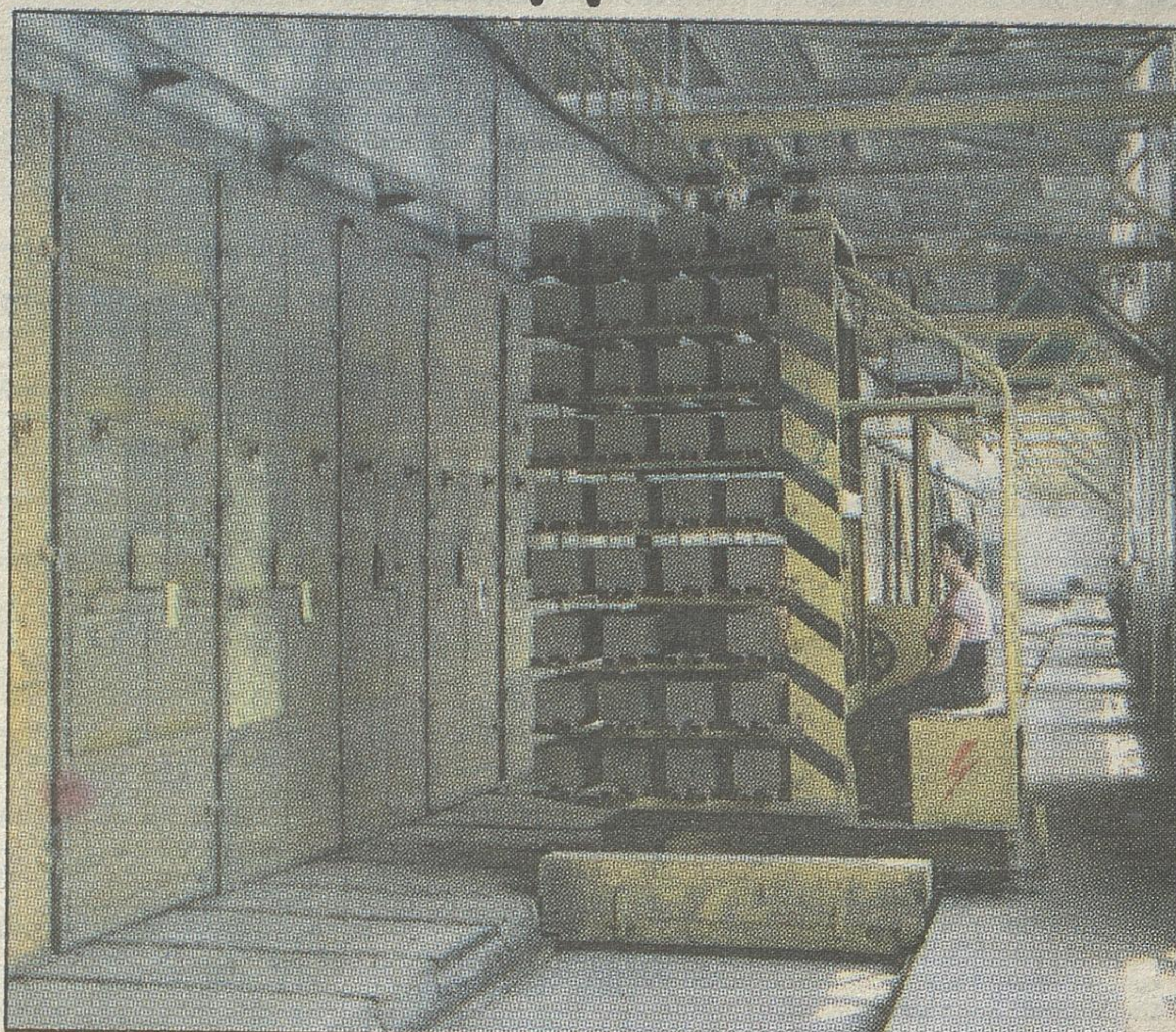
Za pomocą suwnicy uformowane materiały ceramiczne są przewożone do komór suszarni
