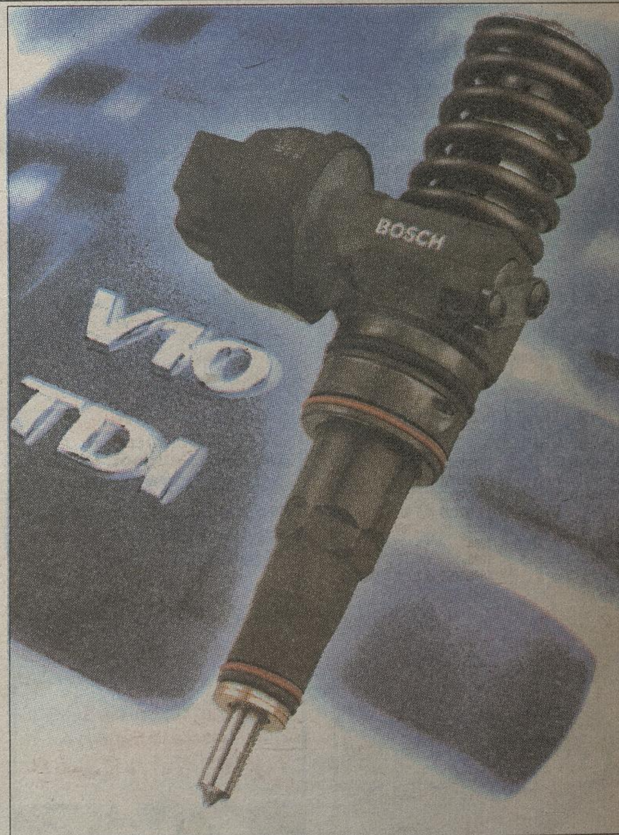
W systemie bezpośredniego wtrysku oleju napędowego UIS Boscha, w nowym VW Touareg sterowane przez dwa sterowniki pompowtryskiwacze wtryskują paliwo bezpośrednio do cylindrów pod ciśnieniem sięgającym maksymalnie 2050 barów
