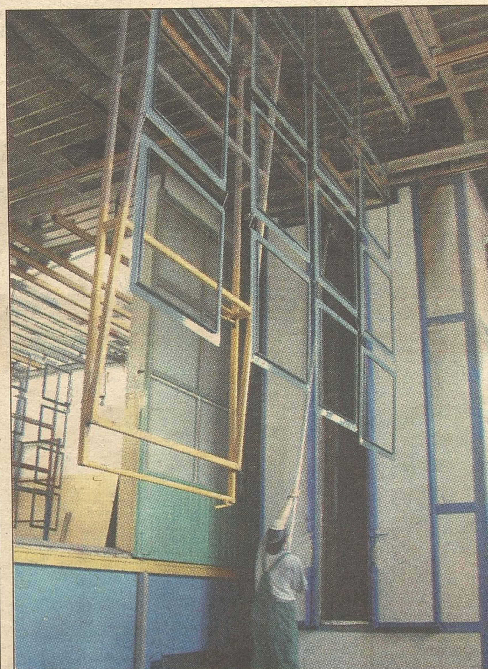
Ogrodzenie metalowe wymaga dokładnego zabezpieczenia przed korozją. Gwarancją jakości jest malowanie proszkowe. Na zdjęciu malarnia proszkowa w białostockim Wimarze. Podczas naszej wizyty w firmie „spod pędzla” wyjeżdżały nie ogrodzenia lecz metalowe elementy, które pojadą do holenderskiego ZOO
