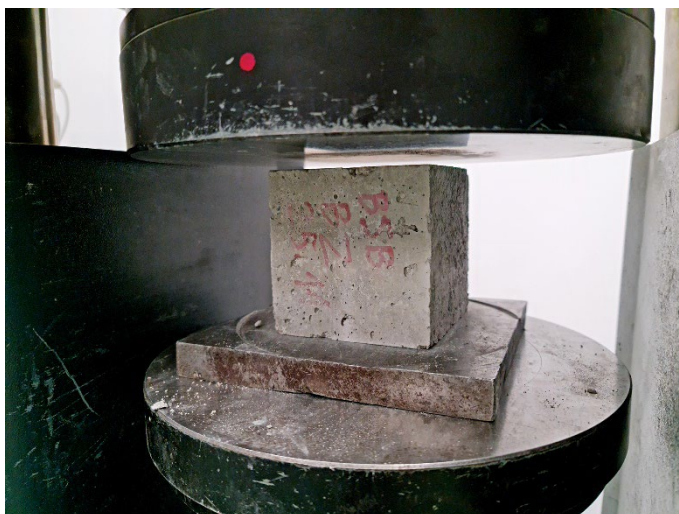
Rys. 5.3. Stanowisko badawcze do badań wytrzymałościowych betonów. Wybrana z przedmiotowych badań próbka badawcza
