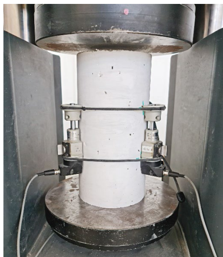
Rys. 5.4. Maszyna wytrzymałościowa Controls wraz z przygotowaną próbką do badań modułu sprężystości
