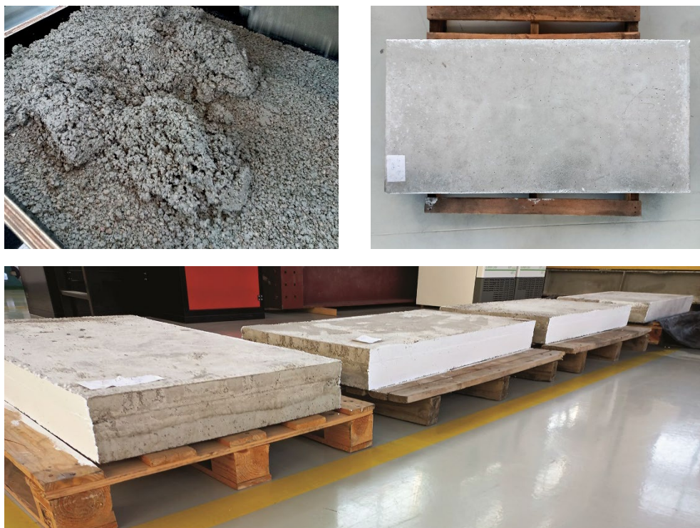
Rys. 5.19. Betonowanie płyty i gotowe elementy badawcze
