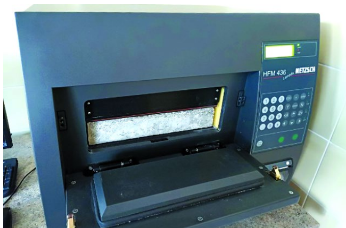
Rys. 5.14. Aparat płytowy HFM436 do pomiaru strumienia ciepłego metodą stacjonarną wtórną z próbką perlitobetonu
