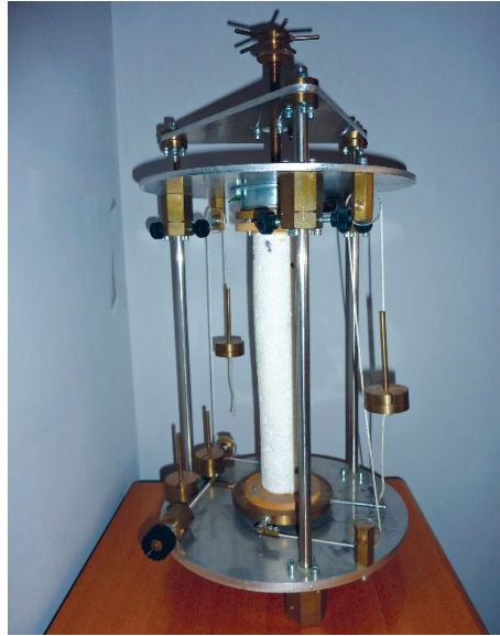
Rys. 5.10. Przyrząd służący do wyznaczania modułu Kirchoffa dla próbki poddanej skręcaniu (fot. W. Buczkowski)
