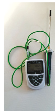
RYS. 2. Urządzenia pomiarowe: 2a) miernik poziomu dźwięku DSA-50 SONOPAN, 2b) anemometr TESTO 417 z miernikiem TESTO 435, 2c) termopara K NiCr-Ni z miernikiem Ahlborn
