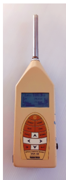
RYS. 2. Urządzenia pomiarowe: 2a) miernik poziomu dźwięku DSA-50 SONOPAN, 2b) anemometr TESTO 417 z miernikiem TESTO 435, 2c) termopara K NiCr-Ni z miernikiem Ahlborn
