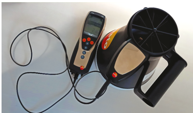
RYS. 2. Urządzenia pomiarowe: 2a) miernik poziomu dźwięku DSA-50 SONOPAN, 2b) anemometr TESTO 417 z miernikiem TESTO 435, 2c) termopara K NiCr-Ni z miernikiem Ahlborn
